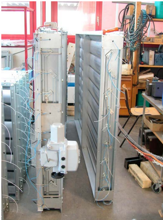
Beheizte Klappe mit Getriebemotor
